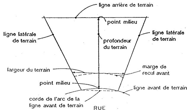
La largeur du terrain correspond à une ligne droite touchant en un point à la marge de recul avant et parallèle à la corde de l'arc rejoignant les deux extrémités de la ligne avant de terrain.
