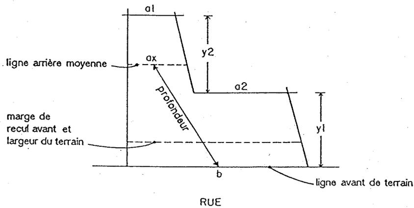
Si la longueur du segment de la ligne arrière de terrain la plus éloignée (a1) représente moins de 50% de la ligne avant de terrain (b), la profondeur du terrain correspond à la distance entre le point milieu de la ligne avant du terrain et le point milieu d'une ligne arrière moyenne  $ax = y1 + \left[ y2 \left[ \frac{a1}{b} \right] \right]$
