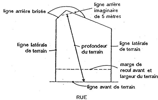
La profondeur du terrain est calculée entre le point milieu de la ligne avant de terrain et le point milieu d'une ligne arrière imaginaire de 5 mètres de largeur joignant les segments d'une ligne arrière brisée et perpendiculaire à la profondeur.
