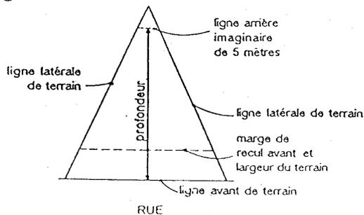
La profondeur du terrain est calculée entre le point milieu d'une ligne avant du terrain et le point milieu d'une ligne arrière imaginaire de 5 mètres de largeur rejoignant les lignes latérales et perpendiculaire à la profondeur.
