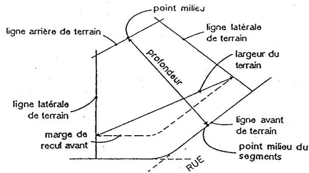
La profondeur du terrain correspond à la ligne droite, la plus distante entre le milieu de la ligne arrière de terrain et le milieu du segment le plus grand.
