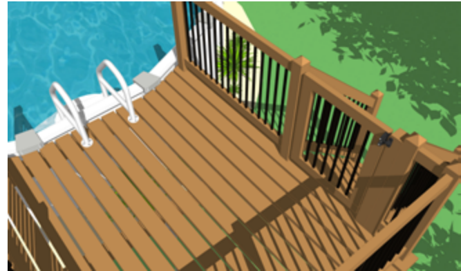
Exemple de porte dont le loquet se situe du côté intérieur de l'enceinte.
