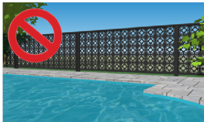
Exemple de clôture ornementale qui peut être escaladée facilement.
